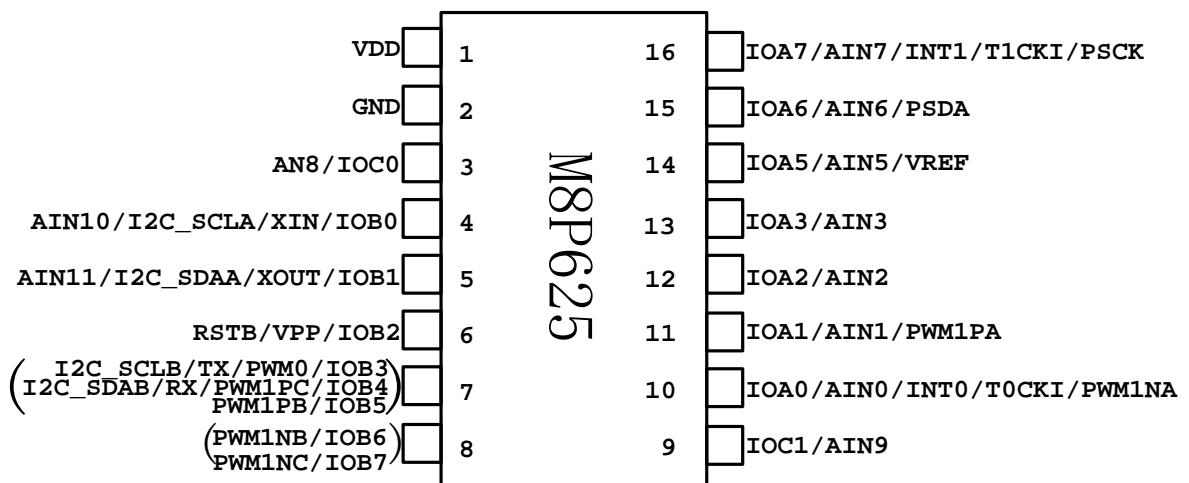
注：引脚 7 是 IOB3、IOB4、IOB5 内部是短接在一起的，引脚 8 是 IOB6、IOB7 内部是短接在一起的，用到其中一个 IO 时，另外的 IO 用做输入。
